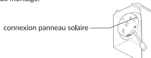
moteur tubulaire à l'intérieur d'un store
